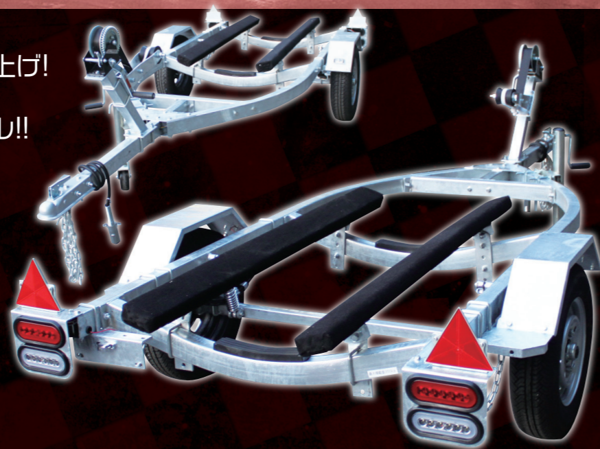
ショックアブソーバ標準装備 L型バウスタンド標準装備 三角リフレクター位置変更 ニップル付きでクリスガンで簡単にクリスアップ
