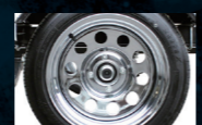
ニップル付きよりグリスガンで容易にグリスアップ可能
